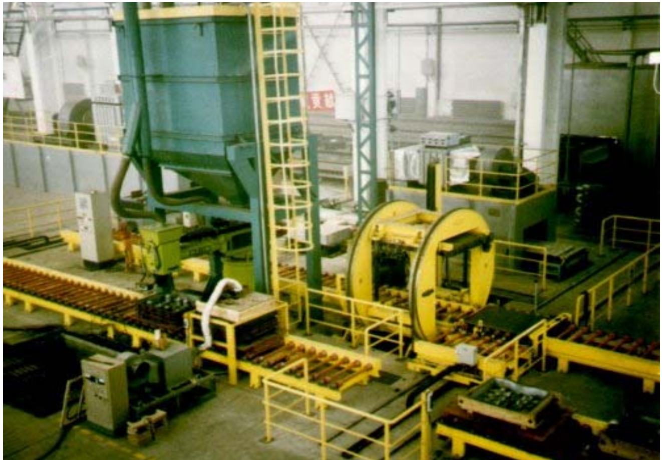
Bild 8: hoch-automatisierte Kaltharz-Formanlage (Daqing, China)
