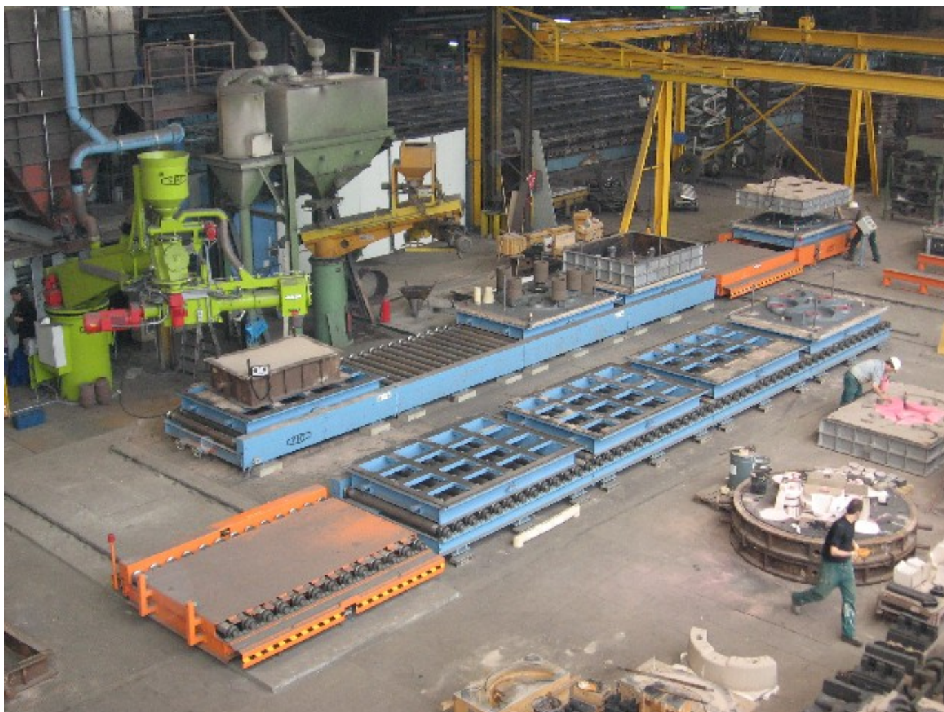
Bild 7: teil-automatisierte Kaltharz-Formanlage (FWH, Mülheim)
