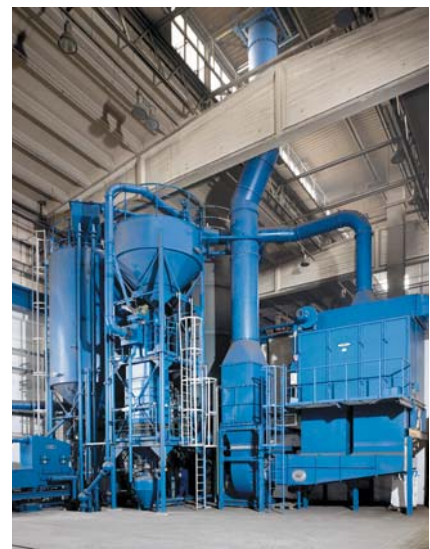
Рисунок 2. Установка регенерации формовочного материала по Альфа-сет-процессу
