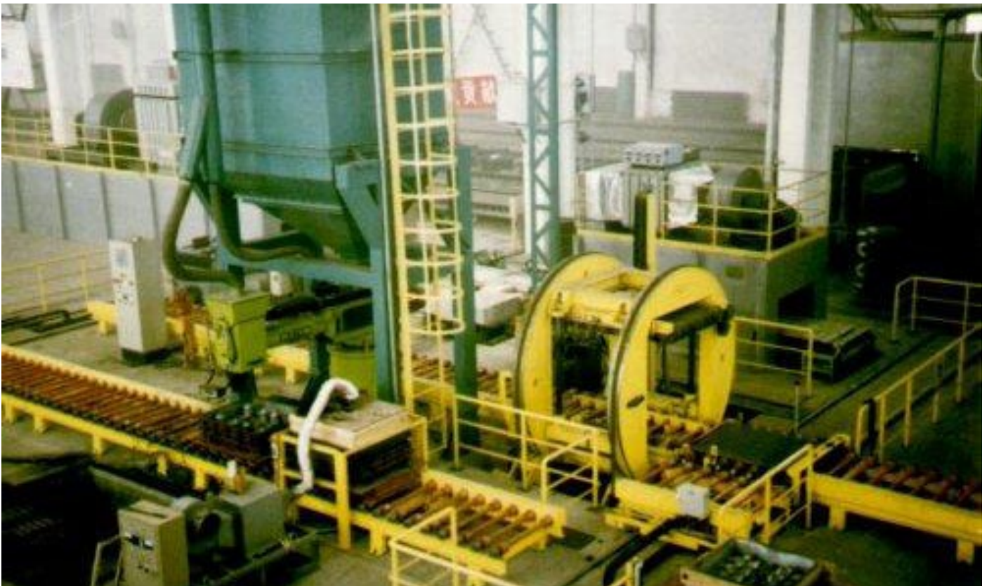
Bild 8: hoch-automatisierte Kaltharz-Formanlage (Daqing, China)
