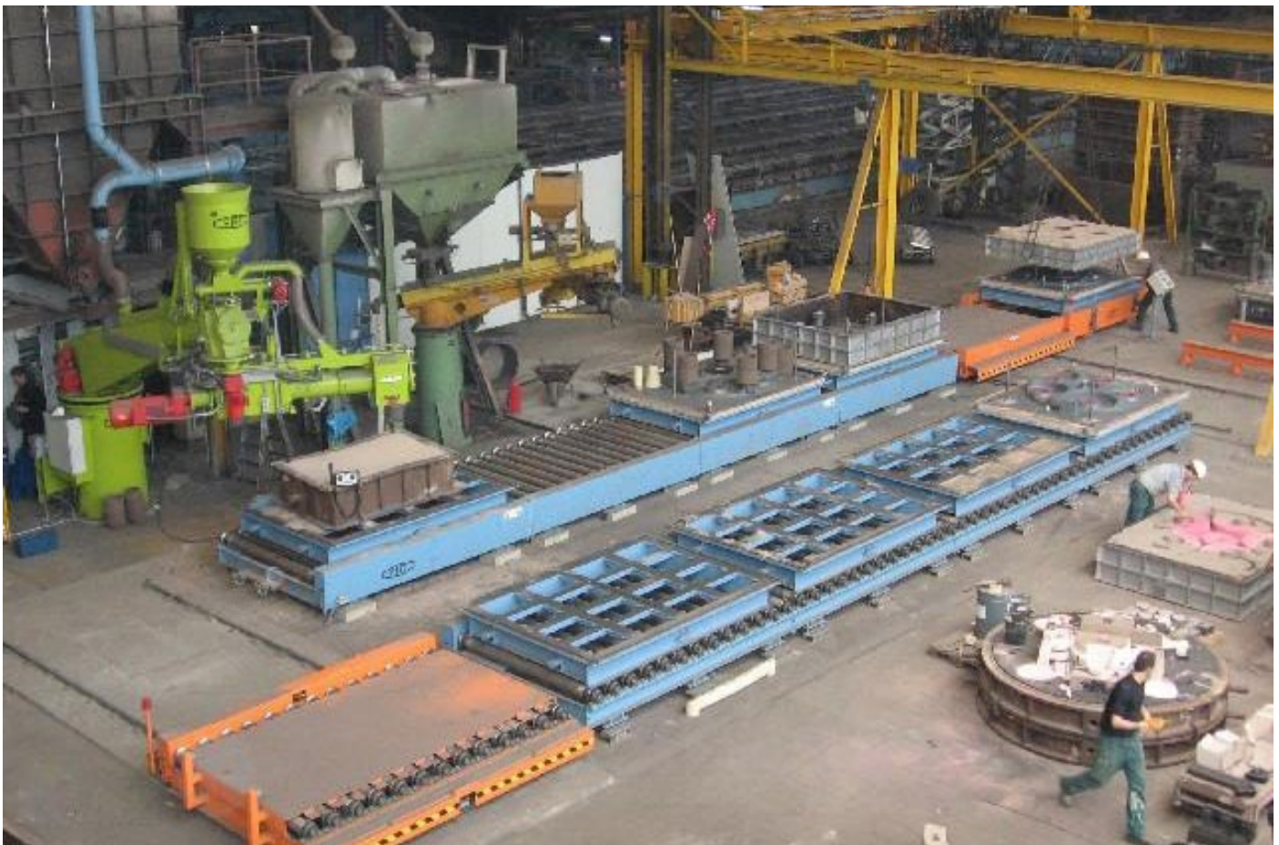
Bild 7: teil-automatisierte Kaltharz-Formanlage (FWH, Mülheim)
