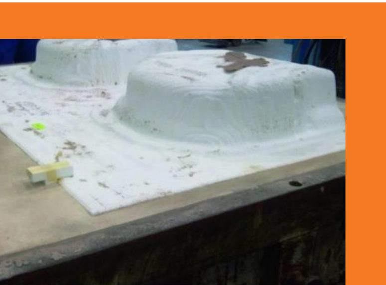
**Bild 6:** Styropormodell nach Entformen
