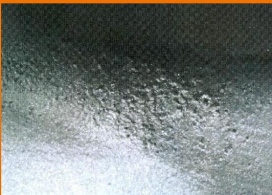
**Bild 5:** Gussteiloberfläche aus einer Form mit einem Anlegesand aus 50% Neusand und 50% mechanischem Regenerat
