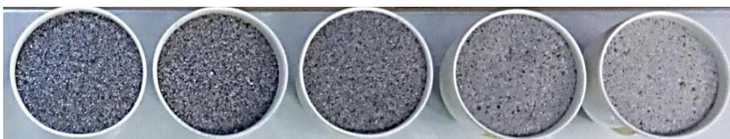
**Bild 3:** Nach Optimierung von Temperatur, Verweilzeiten etc.: thermisch regenerierter Quarzsand
