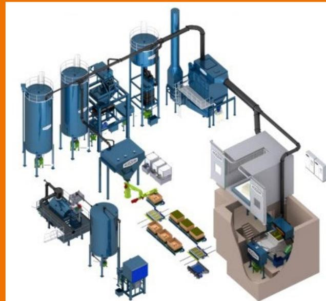
Bild 1: Beispielhafter Formstoffkreislauf
