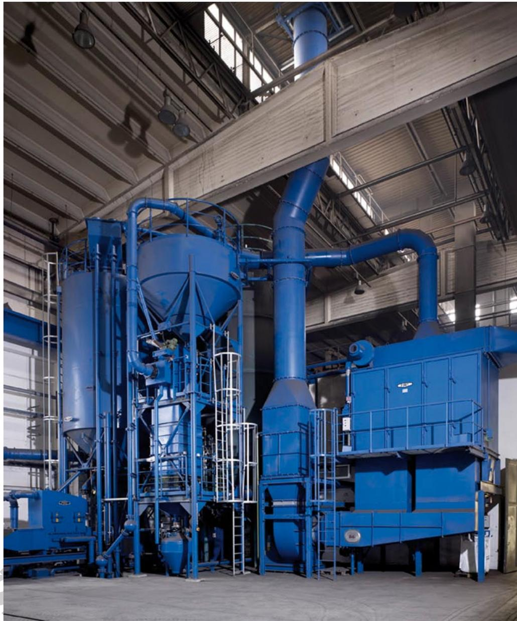
**Bild 2:** Regenerierung für Alpha-Set-Formstoff
