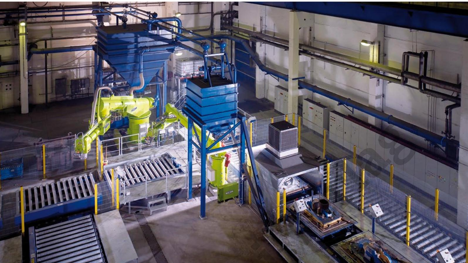
**Bild 1:** Kastengebundene Alpha-Set-Formanlage
