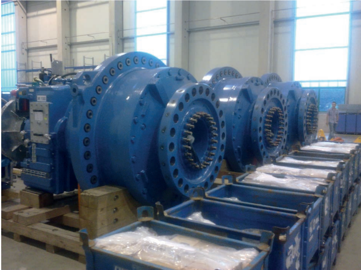
Getriebe, Enercon Gussteil ähnlich
