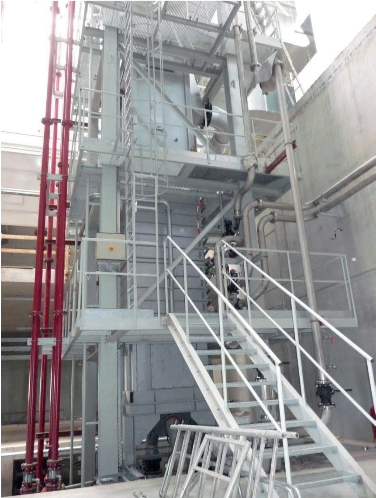
FAT-Sandregenerierung mit Kaskadensichter und Staukühler
