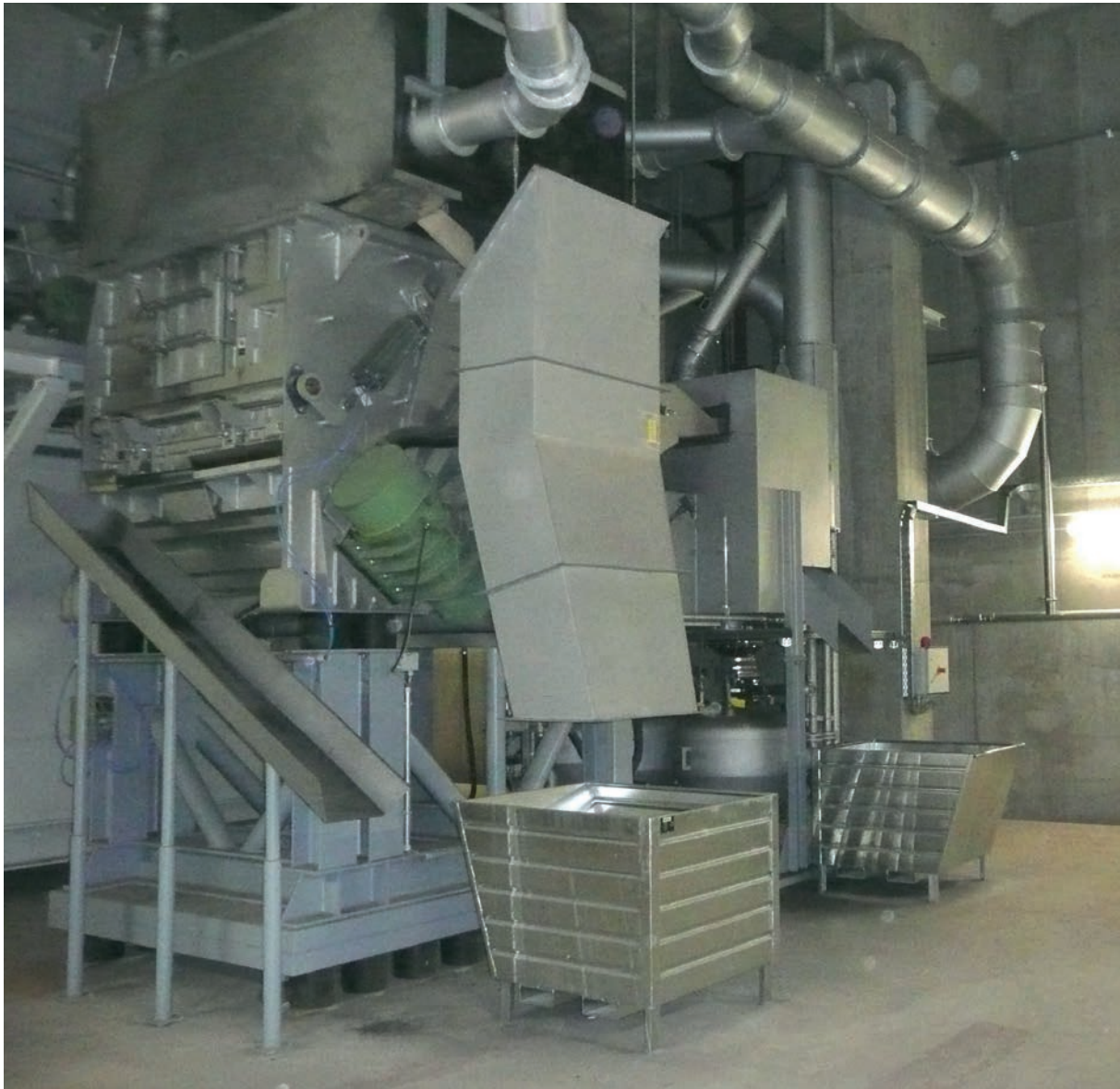
Zerkleinerungsstation mit 2 Vibrationsknollenbrechern (Leistung 2 x 30 t/h)
