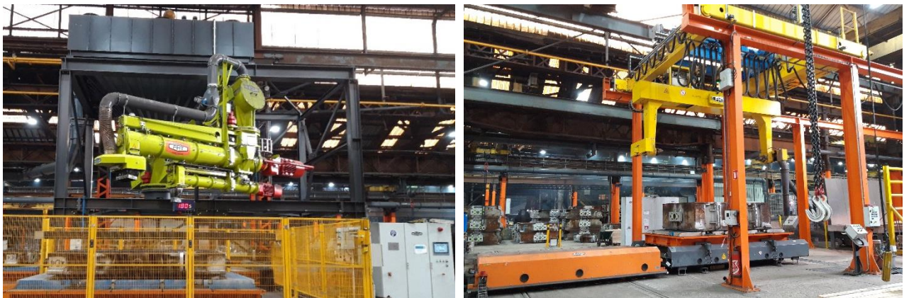
Bild 1: Durchlaufmischer Typ DF-K (links); Ausdrückstation (rechts)
