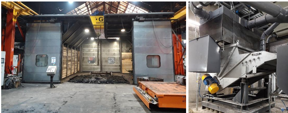
Bild 2: Durchfahrkabine (links); Knollenbrecherstation Typ VKB 3530 (rechts)
