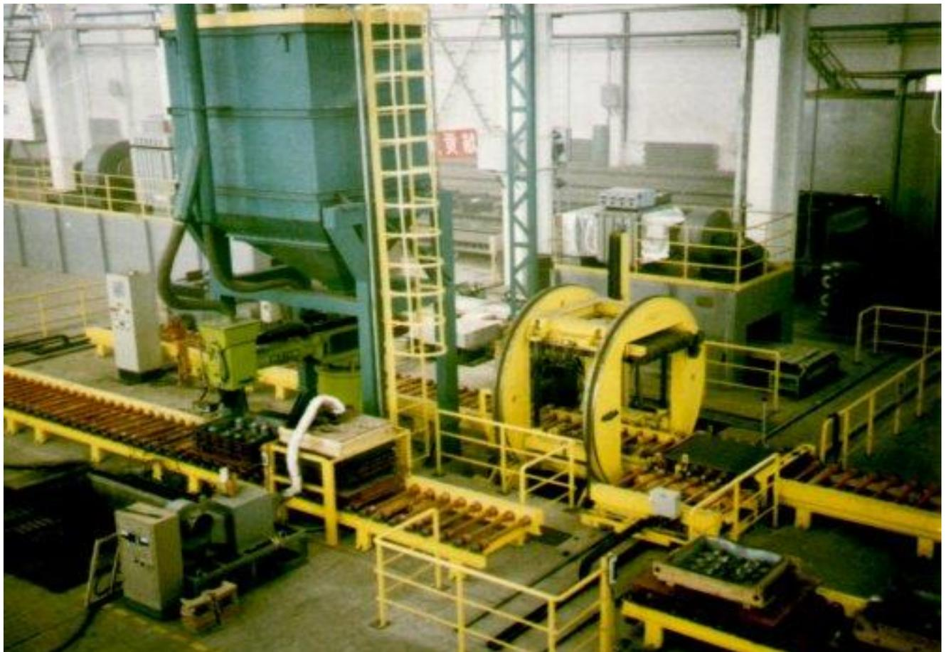
Bild 8: hoch-automatisierte Kaltharz-Formanlage (Daqing, China)
