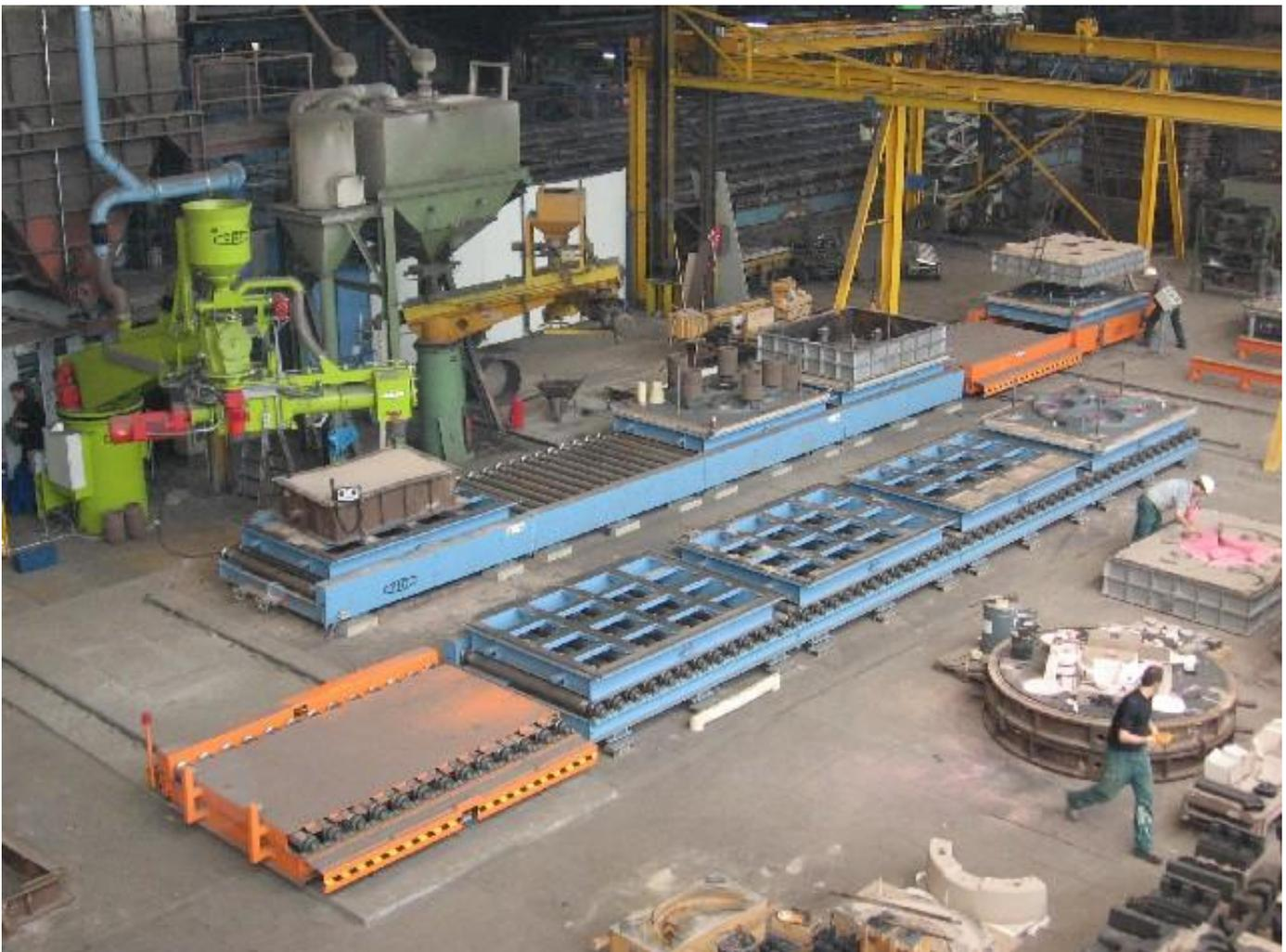
Bild 7: teil-automatisierte Kaltharz-Formanlage (FWH, Mülheim)
