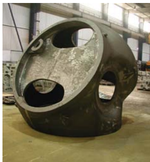
Рис. 1. Отливка по ХТС-процессу, изготовленная на оборудовании фирмы FAT, Германия. Корпус несущего вента ветряка, 3800 x 3300 x 2965 мм, масса 26415 кг. Материал EN-GJS-400-18U-LT. Завод Meuselwitz Guss
