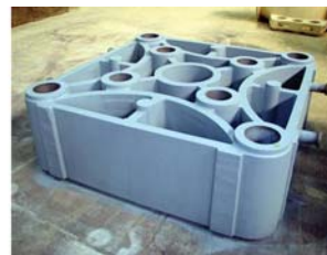
Рис. 16. Прессовый стол, размеры 3020 x 3020 x 1100 мм, 27900 кг. Сплав: EN-GJS-400-15 по DIN EN 1561
