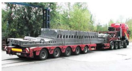
Рис. 15. Поперечная балка, размеры 11750 x 1860 x 1380 мм, 49700 кг. Сплав EN-GJS-600-3 по DIN EN 1561
