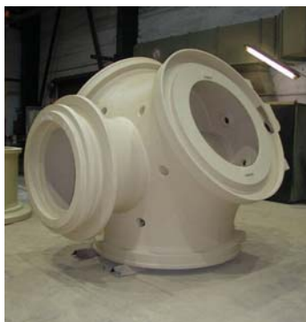
Рис. 2. Корпус винта ветряка, 3200 x 2930 x 2925 мм, масса 9530 кг. Материал EN-GJS-400-18U-LT. Формовка по ХТС-процессу на оборудовании фирмы FAT
