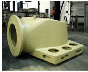
Рис. 8. Отливка – элемент генератора, размеры 3060 x 2850 x 1775 мм, 7770 кг. Сплав EN-GJS-400-18U-LT
