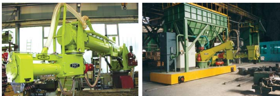
Рис. 7. Передвижной и стационарный смесители (регулируемые по высоте) по ХТС-процессу моделей DF (производительность 22–62 т/ч). Область применения – изготовление больших форм со сложным рельефом
