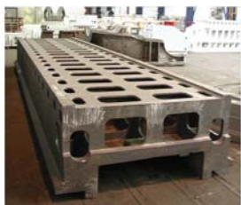
Рис. 14. Станина, размеры 8600 x 2300 x 960 мм, 23280 кг. Сплав EN-GJL-250 по DIN EN 1561
