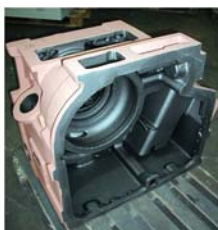
Рис. 19. Корпусная отливка, размеры 1020 x 945 x 645 мм, 410 кг. Сплав EN-GJL-200 по DIN EN 1561
