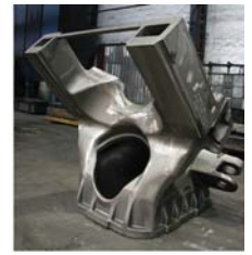
Рис. 12. Опорная рама, размеры 3390x2990x1570 мм, 5995 кг. Сплав EN-GJS-400-18U-LT
