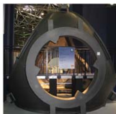
Рис. 20. Втулка несущего винта для ветряного двигателя, 43000 кг, сплав EN-GJS-400-18U-LT. Производитель: Friedrich-Wilhelms-Hütte GmbH
