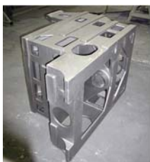
Рис. 17. Станина, размеры 1260 x 900 x 900 мм, 515 кг. Сплав EN-GJL-200 по DIN EN 1561
