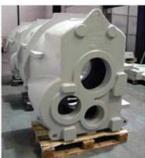
Рис. 18. Корпусная отливка, размеры 1670 x 1510 x 930 мм, 2265 кг. Сплав EN-GJL-250 по DIN EN 1561
