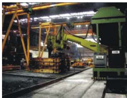
Рис. 5. Передвижной смеситель непрерывного действия фирмы FAT производительностью 30 т/ч
