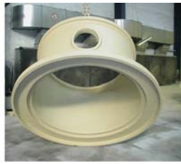
Рис. 9. Переходник лопасти, диаметр 2265 x 1300 мм, 2390 кг. Сплав EN-GJS-400-18U-LT
