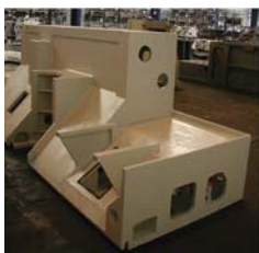
Рис. 13. Станина, размеры 4810 x 1410 x 1440 мм, 6220 кг. Сплав EN-GJL-250 по DIN EN 1561
